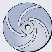
Рис.1.2.15: Типы рабочих колес для канализационных стоков
