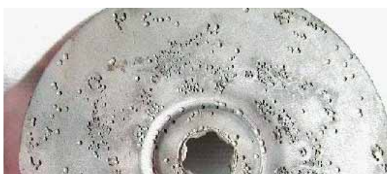
Точечная коррозия стали 1.4401 (AISI 316)
