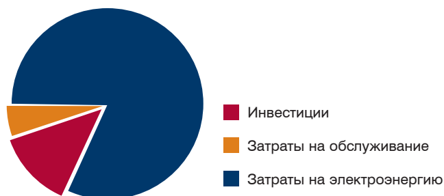
Рис. 5.1.2. Типичная диаграмма стоимости жизненного цикла циркуляционной системы в промышленности
