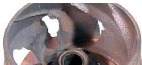
Эрозийная коррозия чугунного рабочего колеса
