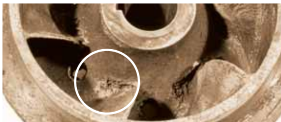
Кавитационная коррозия бронзового рабочего колеса
