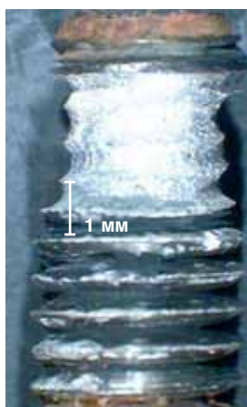
Щелевая коррозия стали 1.4462 (SAF 2205)
