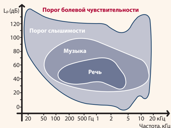
Рис. 2.1.15: Уровень звукового давления в зависимости от частоты звуковых колебаний
